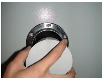
测试孔遮盖物（硅胶塞）
